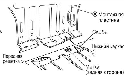
Монтажную пластину следует монтировать на стене, способной выдержать вес внутреннего блока.
