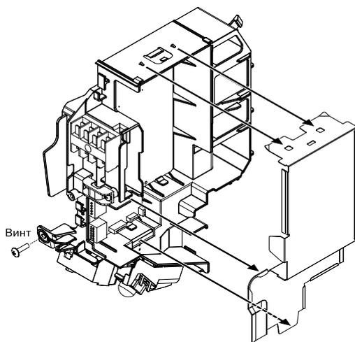
2) Снимите блок электропроводки.
