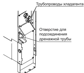
Подсоедините дренажную трубу после удаления резиновой пробки и изоляционной трубки, прикрепленной к соединительному отверстию.
