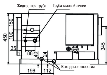
Вид со стороны трубопровода
