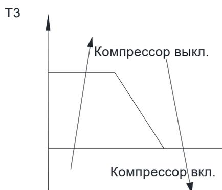
При T3 выше установленного значения, компрессор выключается.
